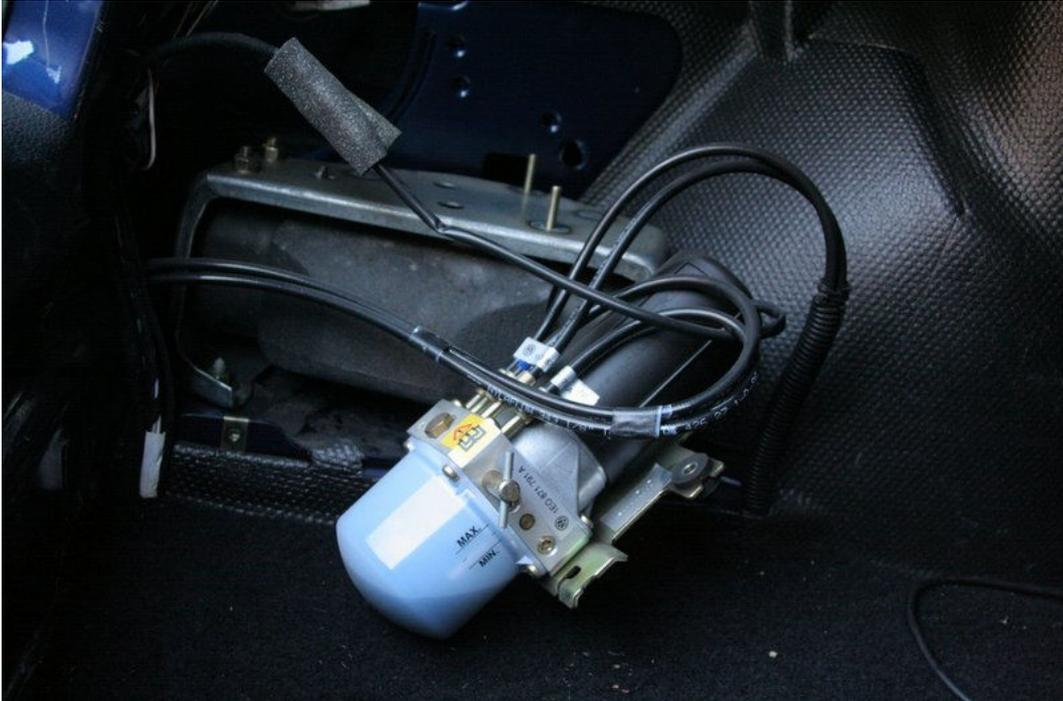
4. Die Pumpe in eine kleine Schale stellen, falls Öl austritt (war bei mir nicht der Fall, man braucht also evtl. nur ein Tuch anstelle der Schale). Danach die zwei Torx (TX25) Schrauben lösen, die den Elektromotor mit der Pumpe verbinden und den Motor von der Pumpe abziehen.
