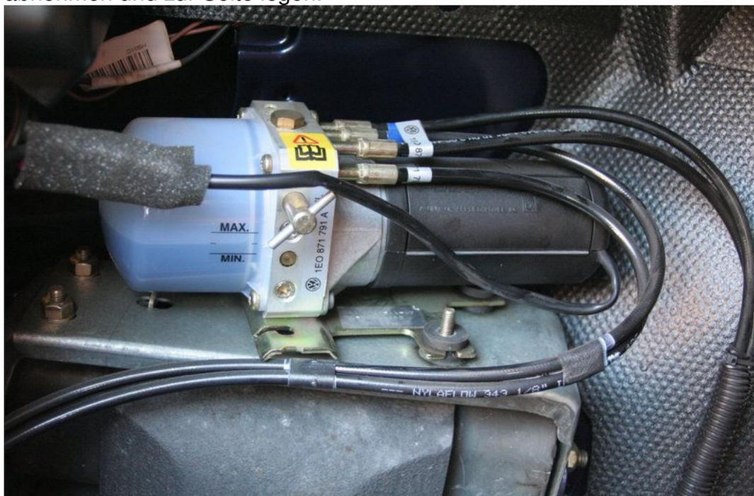
2. Den Kabelbinder, der die Hydraulikschläuche und Stromkabel an der Pumpe befestigt, entfernen. An dieser Stelle haben viele Beschreibungen auch die Stromkabel von der Pumpe gelöst, ich habe jedoch keinerlei Kabel bzw. Schläuche entfernt.
