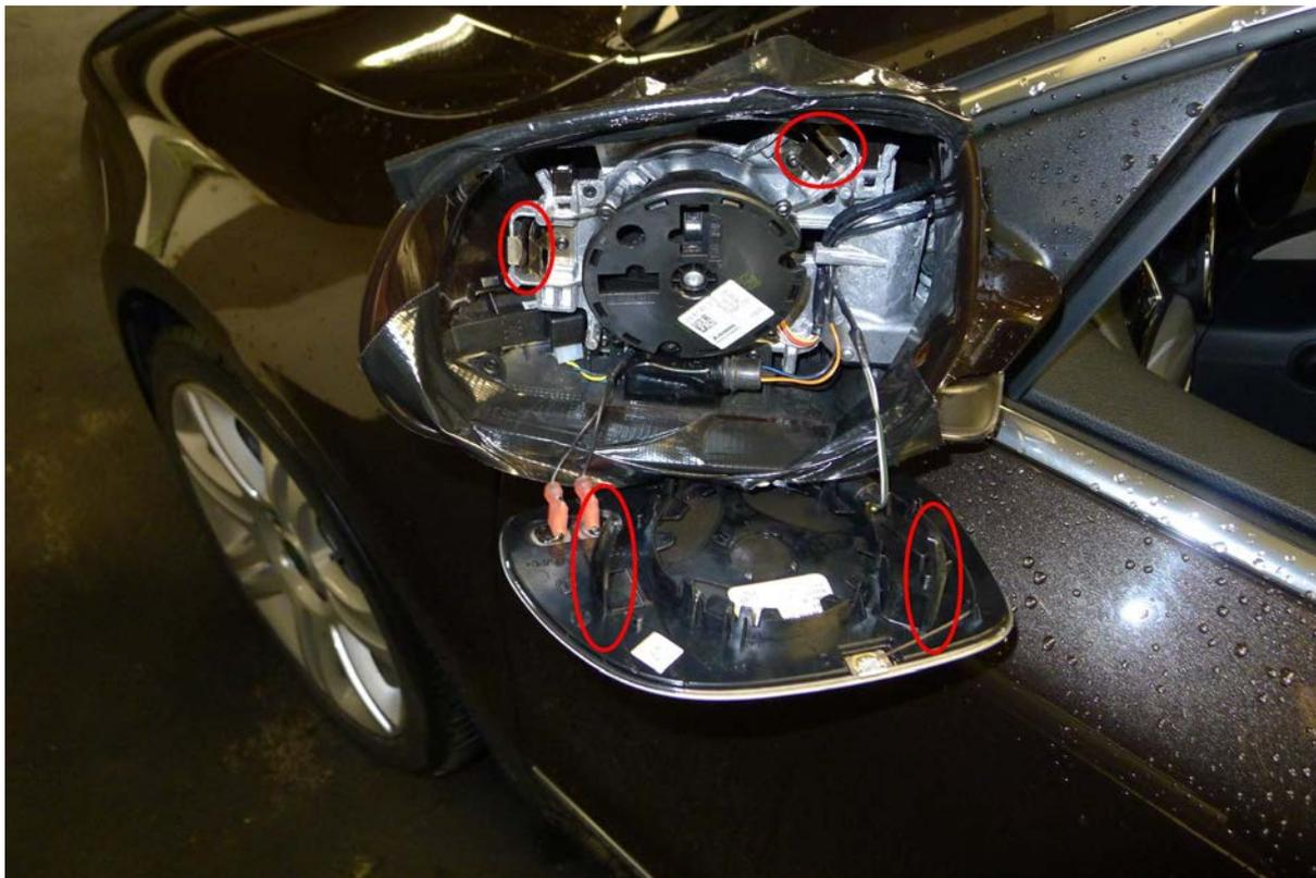
Wenn alle Zapfen eingerastet sind bzw. das Spiegelglas wirklich fest sitzt, kann das Klebeband bzw. Gewebepband vorsichtig vom Spiegelgehäuse entfernt und der Spiegel wieder zurück geklappt werden. Ein **abschließender Funktionstest** (elektrische Spiegelverstellung) sollte hoffentlich die Gewissheit bringen, daß alles in Ordnung ist und der Umbau funktioniert hat.
