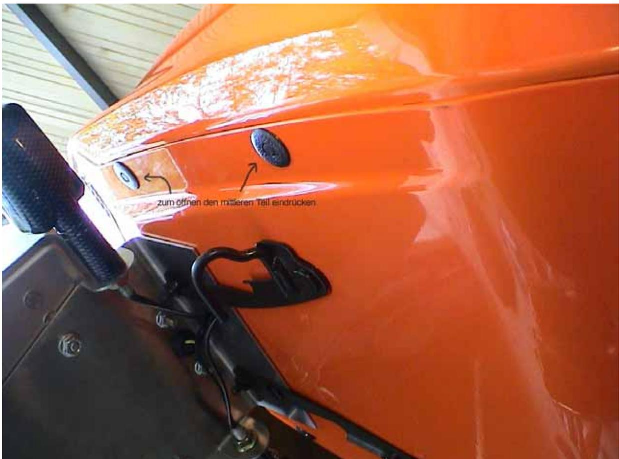
**Beide Teile der Sitzbank lösen. Die 2 Schrauben am Heck (unter der Sitzbank) lösen. Nun die Nippel des oberen Verkleidungsteils vorne aus den Gummihaltern nehmen**
